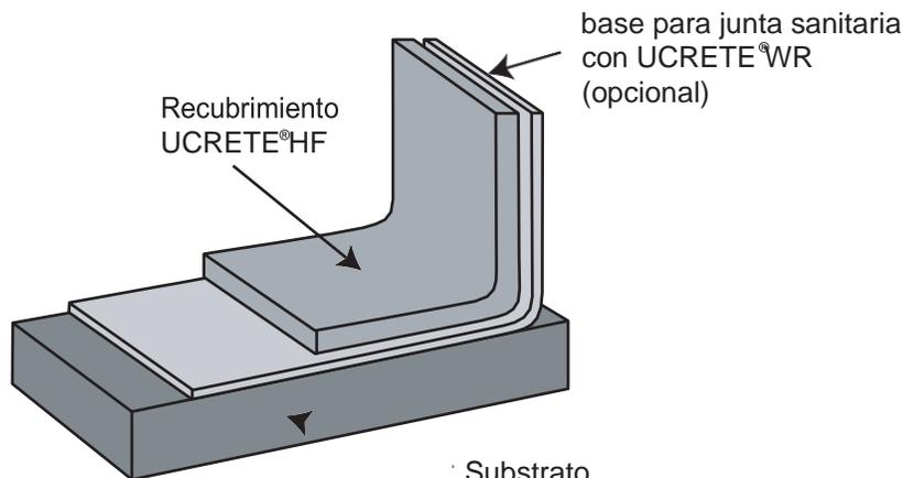
para pisos nuevos y existentes. Mecánicamente, profile el piso por lo menos a 3 CSP (aproximadamente como es determinado por el Instituto Internacional de Reparación del Concreto (ICRI). No use tratamiento con ácido para la preparación de la superficie. No use ningún método que fracture el concreto.
